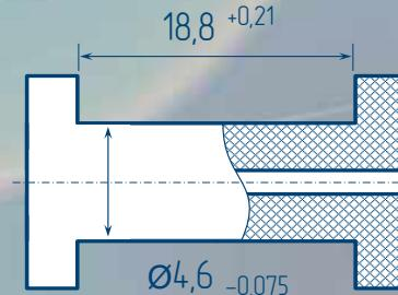
5000 витков, провод Ø 0,063 мм
